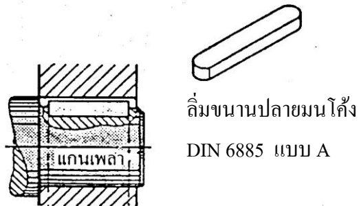
รูปที่ 5.14 ลิ่มขนานปลายมนโค้งตาม DIN 6885 แบบ A
