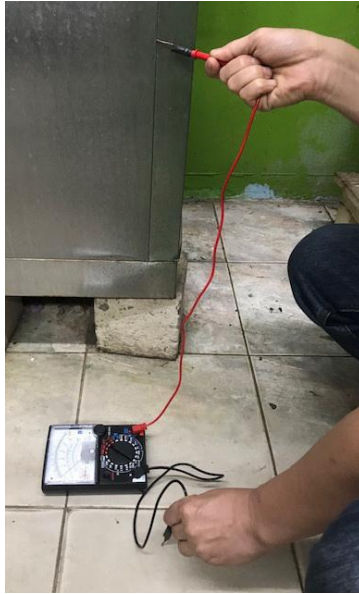
รูปที่ 9.9 การตรวจสอบอุปกรณ์ไฟฟ้ารั่วลงดิน
