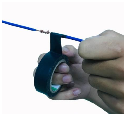
รูปที่ 2.9 การพันเทปพันสายต่อแบบเกี่ยวก้อย
