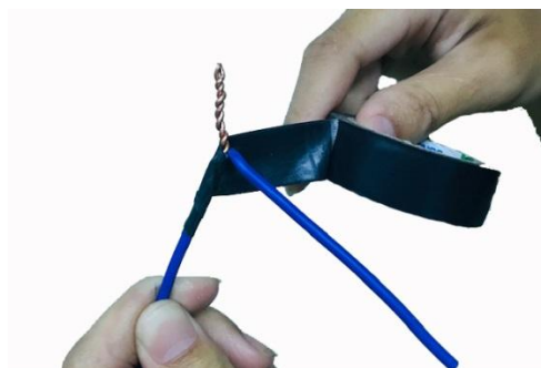
รูปที่ 2.10 การพันเทปพันสายต่อแบบหางเปีย
