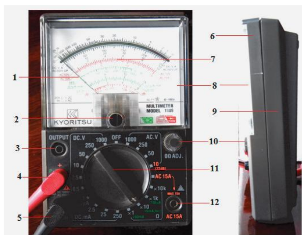
รูปที่ 2.1 ส่วนประกอบของมัลติมิเตอร์แบบอนาล็อก
