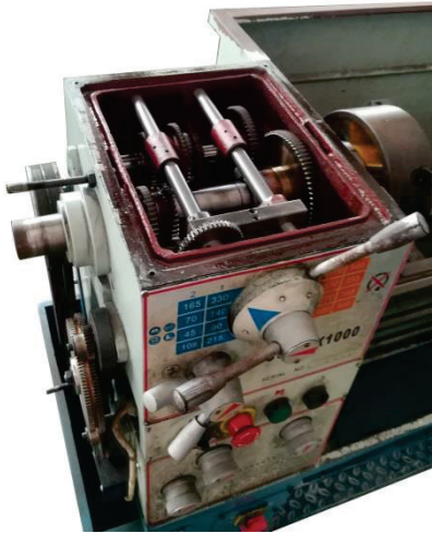
รูปที่ 4.9 แสดงลักษณะของชุดเฟืองทดในชุดหัวเครื่องกลึงยืนศูนย์ (ที่มา : สุรัชย์ บุญโสภณ, 2559)
