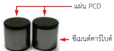
(ข) แท่งซีเมนต์คาร์ไบด์ที่มีผลึกเพชร ประสานด้วยโคบอลต์เกิดเป็นแผ่นฟิล์มสีดำ
