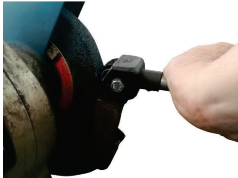
รูปที่ 3.13 แสดงลักษณะการวางด้ามจับล้อแต่งหน้าหินเจียรไนบนแท่นรองรับชิ้นงาน (ที่มา : สุรัชย์ บุญโสภณ, 2559)
