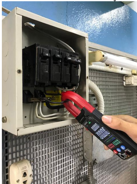
รูปที่ 9.10 วัดกระแสไฟฟ้าด้วยแคลมป์-ออน แอมมิเตอร์
