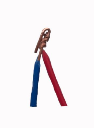
รูปที่ 2.6 การต่อสายแข็งกับสายอ่อน
