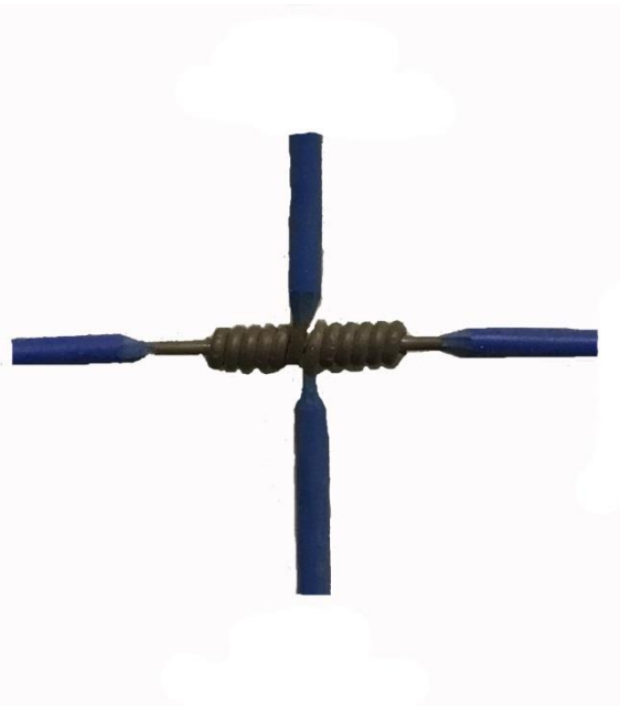
รูปที่ 2.5 การต่อสายแบบแยก 4 ทาง
