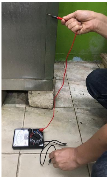
รูปที่ 9.9 การตรวจสอบอุปกรณ์ไฟฟ้ารั่วลงดิน
